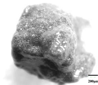
圖 6 初始磨料外觀形貌；12 μm-50%
